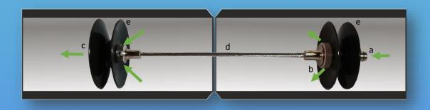
Zum Formieren von Kleinleitungen ab li Ø 17 mm bis li Ø 49 mm mit vorderer und hinterer Abdichtung.
