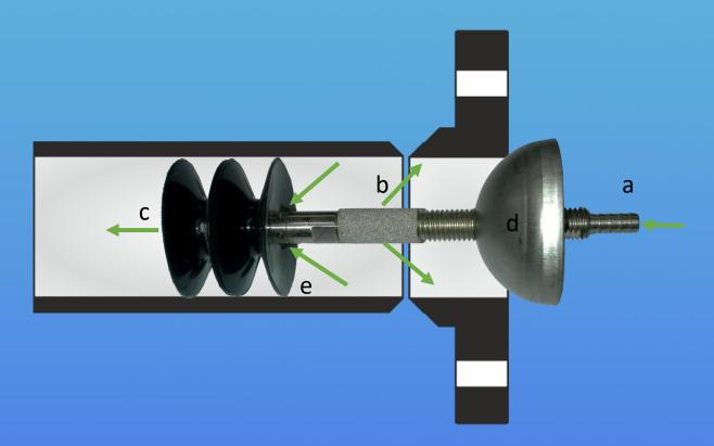
Zum Formieren von Flanschen an Kleinleitungen ab Ø 17 mm bis Ø 49 mm mit Dichtungshalbkugel und hinterer Abdichtung.
