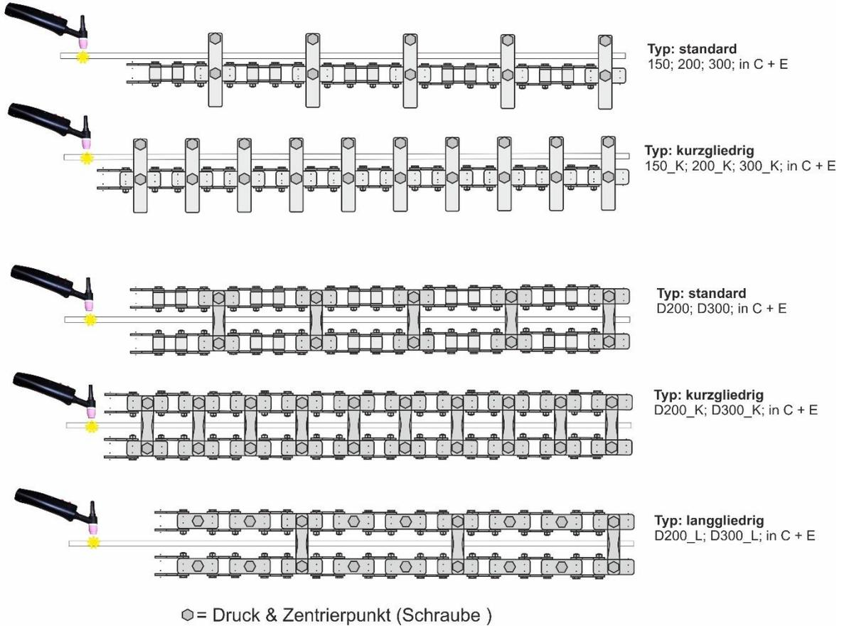
Kettentyp **150** wird eingesetzt ab einen Rohraußendurchmesser von 150 mm, wobei die Wandstärke und die benötigte Stabilität zu beachten ist.
